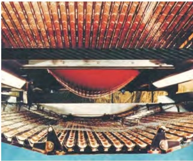
Bild 7: Thermoformanlage für Bootskörper
