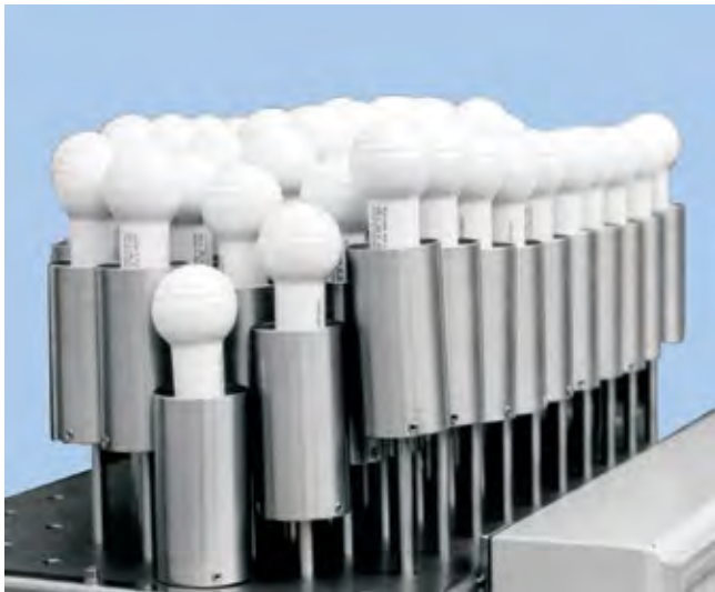
Bild 8: 3-D-Heizfeld zum Kaschieren von Türverkleidungen
